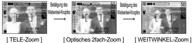
Digitaler WEITWINKEL-Zoom: Ist der Digitalzoom in Betrieb, wird durch drücken der Zoomtaste W der digitale Zoom schrittweise verringert. Wird die Zoomtaste W losgelassen, wird der digitale Zoomvorgang beendet. Durch drücken der W-Taste werden erst der Digitalzoom und anschließend der optische Zoom verringert, bis die minimale Einstellung erreicht ist.
