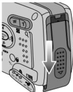
1. Öffnen Sie den Batteriefach-Deckel, indem Sie ihn in Pfeilrichtung schieben.
