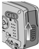
3. Um den Batteriefach-Deckel zu schließen, schieben Sie ihn, bis er einrastet.
